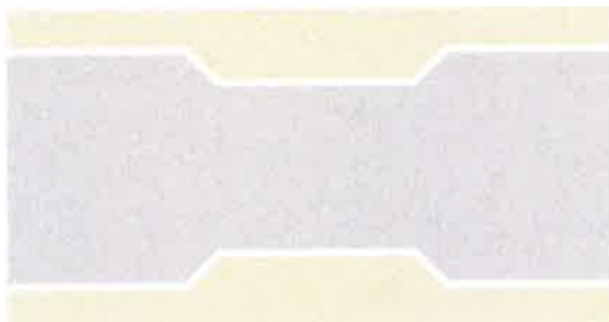
Rétrécissement latéral des deux côtés
